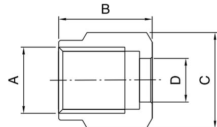
Blindmutter aus Messing / Cap nut, nickel plated:
